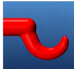
Optimale Anguss-Geometrie, gut verrundet
