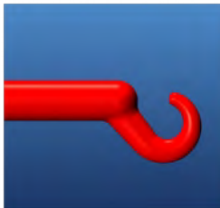
Optimale Anguss-Geometrie, gut verrundet
