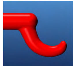
Optimale Anguss-Geometrie, gut verrundet
