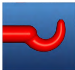
Optimale Anguss-Geometrie, gut verrundet
